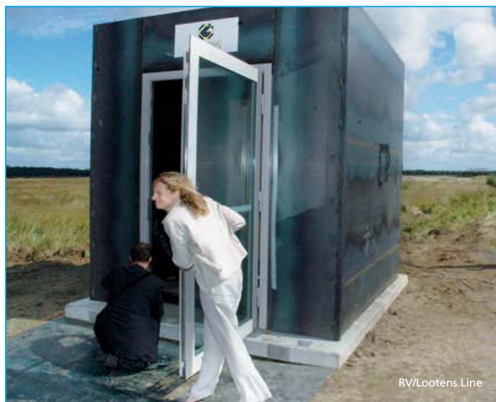
Lootens Line liet de deuren testen op explosiebestendigheid met medewerking van de Koninklijke Militaire School.
